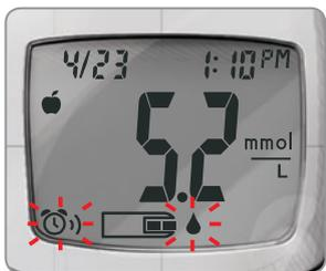
Lorsque l'alarme de rappel se déclenche, l'indicateur se met automatiquement en marche. Le rappel sonne 20 fois et l'écran affiche le résultat de l'analyse Avant repas marquée au moment du réglage du rappel. Vous pouvez arrêter l'alarme en appuyant sur n'importe quel bouton.
