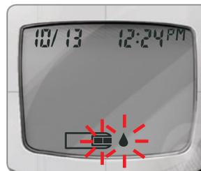
L'indicateur de glycémie se met en marche. Lorsqu'il est prêt pour l'épreuve de vérification, une bandelette d'analyse et une goutte de sang clignotent à l'écran.
