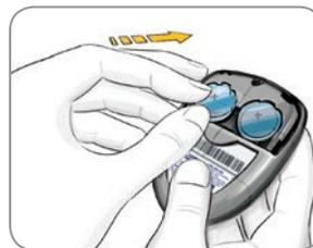
4. Insérez les nouvelles piles dans le compartiment en les glissant sous les encoches et en orientant le symbole « + » vers le haut. [Utilisez deux piles au lithium de 3 volts (DL2032 ou CR2032).]
