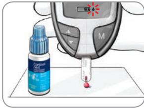
7. Déposez une petite goutte de solution de vérification sur une surface propre et non absorbante. **N'appliquez pas la solution directement sur la bandelette d'analyse ou sur votre doigt.**
