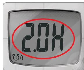
Pour modifier l'heure de l'alarme rappelant d'effectuer une analyse de glycémie après un repas, appuyez sur ▲ ou ▼ pour afficher les différentes options. Sélectionnez 2 h 30, 2 h, 1 h 30 ou 1 h pour régler l'alarme (préréglée à 2 h). Appuyez sur **M** pour valider votre sélection.
