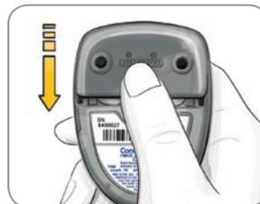
5. Remettez le couvercle en place en l'alignant sur les rainures et refermez-le soigneusement.
