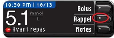
1. Laissez la bandelette d'analyse dans l'indicateur et appuyez sur le bouton **Rappel**.
