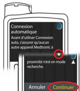
10. Lisez l'écran de la pompe. Assurez-vous que les autres dispositifs de Medtronic à proximité NE sont PAS en mode « recherche ». Utilisez le bouton de défilement vers le bas pour faire défiler jusqu'à la page suivante. Utilisez le bouton de défilement vers le bas pour faire défiler jusqu'à **Continuer**. Appuyez sur le bouton **Sélectionner**.
