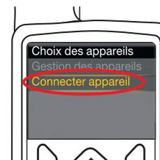
8. Dans le menu **Options de l'appareil**, faites défiler jusqu'à **Connecter appareil**. Appuyez sur le bouton **Sélectionner**.
