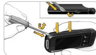
Pour retirer la batterie pour la jeter correctement, vous devez séparer les parties supérieure et inférieure du boîtier.
